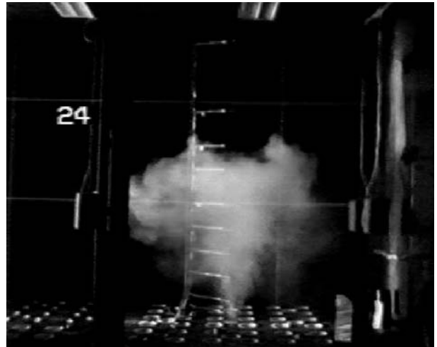
Luftströmung aus BLA, große Eindringtiefe, geringe Luftgeschwindigkeiten
