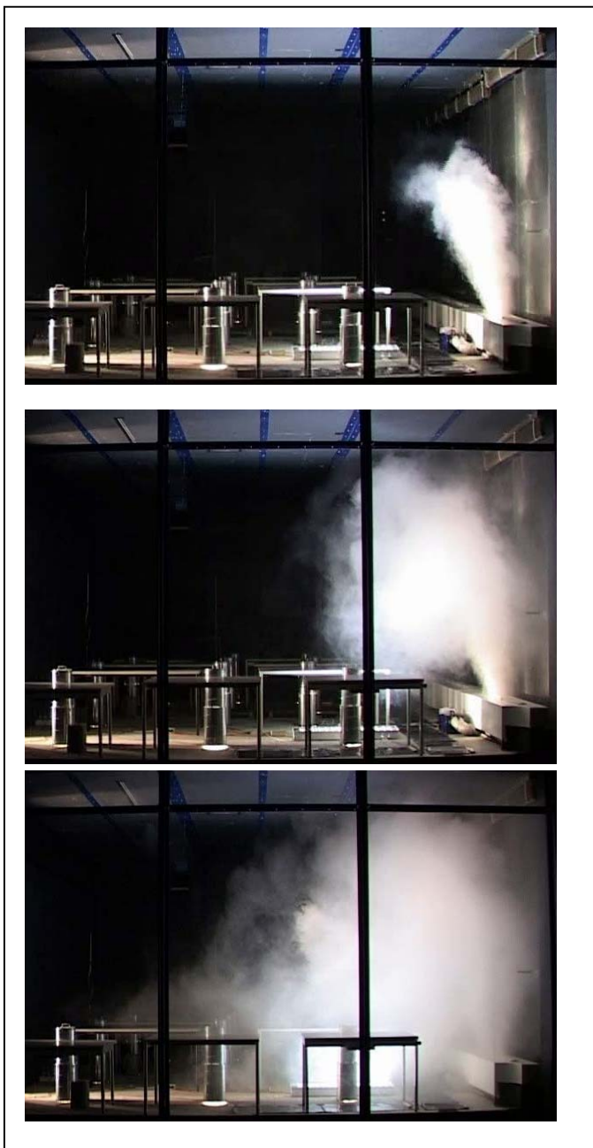
Abbildung 4: Raumströmung einer Misch-Quelllüftung
